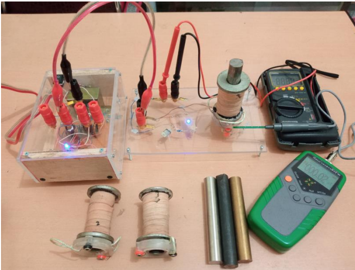
Gambar 31. Alat eksperimen pengujian permeabilitas bahan logam
